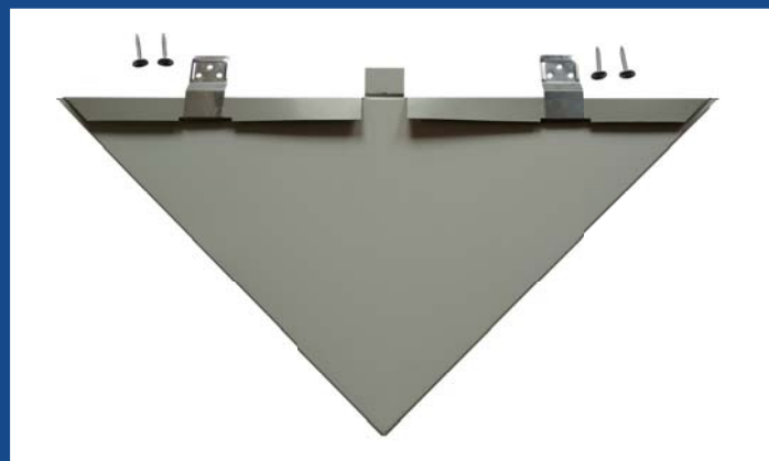
Spodní díl dělené šablony Rombo RPZ 345 SNÍH 2× Rombo příponka D. NEREZ.RPO.8. 4× Šroub SDR 4,2x25/SDR 4,2x25 INOX
